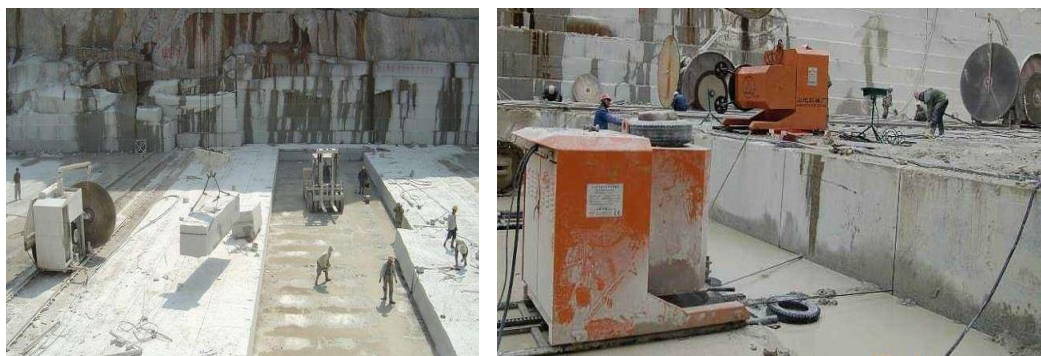
图 6-1 矿山圆盘锯+金刚石串珠绳锯组合开采工艺
